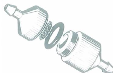
Vous pouvez le nettoyer, il est démontable. Corps en aluminium, grille en inox et joint torique en caoutchouc.
